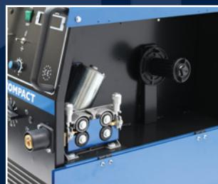
Ampio compartimento para bobinas de hasta 20kg Ø 300mm
