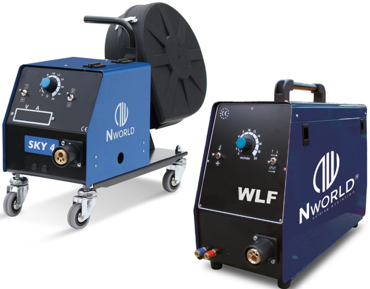
La Serie Sky 4S/WLF 4S ha sido realizada para ser aplicada a los generadores con la regulación a tiros de la tensión de soldadura, como nuestros BLUE ONE. Se presentan completos de: ajuste de la velocidad del hilo, kit 2/4 tiempos, prueba de gas, prueba de alambre; a petición kit digital V+A, caudalímetro y taquímetro. El hilo es empujado por un sistema de tracción de 4 rodillos
