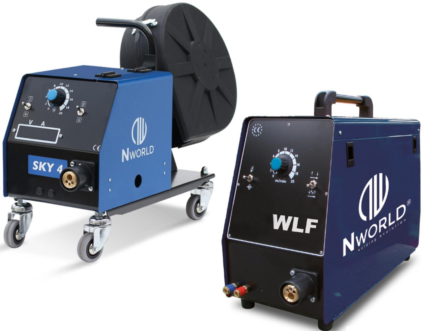
La Série Sky 4S/WLF 4S a été réalisée pour être appliquée aux générateurs avec le réglage par paliers de la tension de soudage, comme nos BLUE ONE. Ils sont équipés de : réglage de la vitesse du fil, kit 2/4 temps, essai de gaz, test du fil; kit numérique V+A, débitmètre et tachymètre. Le fil est poussé par un système de traction à 4 rouleaux.
